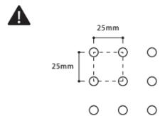
hin×ge の有孔ピッチは 25mm です。有孔ピッチ 25mm に適応するパーツをご使用ください。
